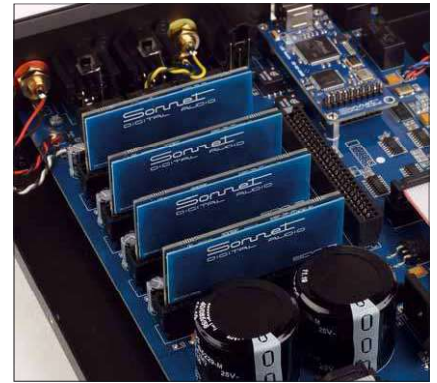
Pro Kanal arbeiten zwei Ladder-DAC-Module an der Umsetzung der Signale
